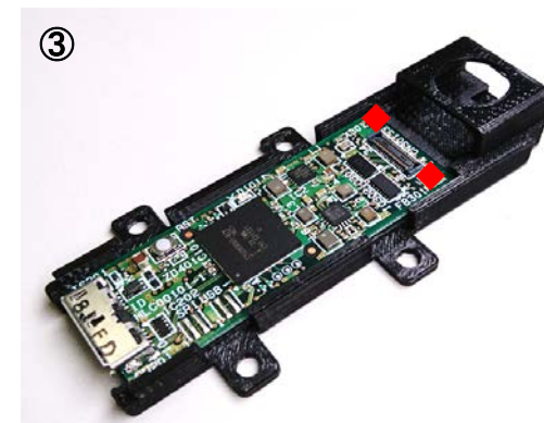
③ ◆部を押し込み、ケースに基板をはめ込む。
